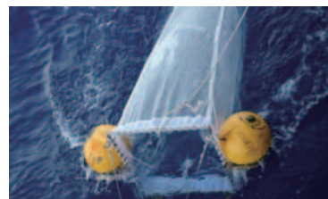
写真5→ (ニューストンネットを 海面に浮かせて採取)
